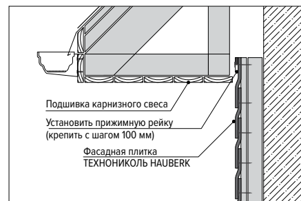
Рис. 9.1. Монтаж верхнего ряда под карнизным свесом
