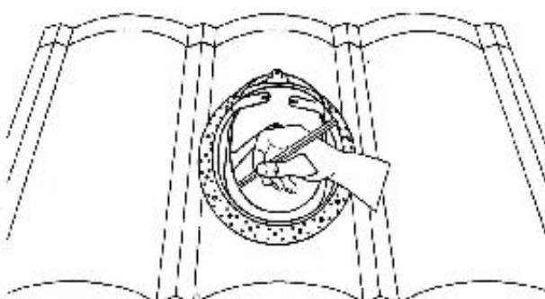
4 В нижней части контура просверлите дрелью рядом два отверстия. Вставьте в него ножницы по металлу и прорежьте отверстие строго по контуру.
